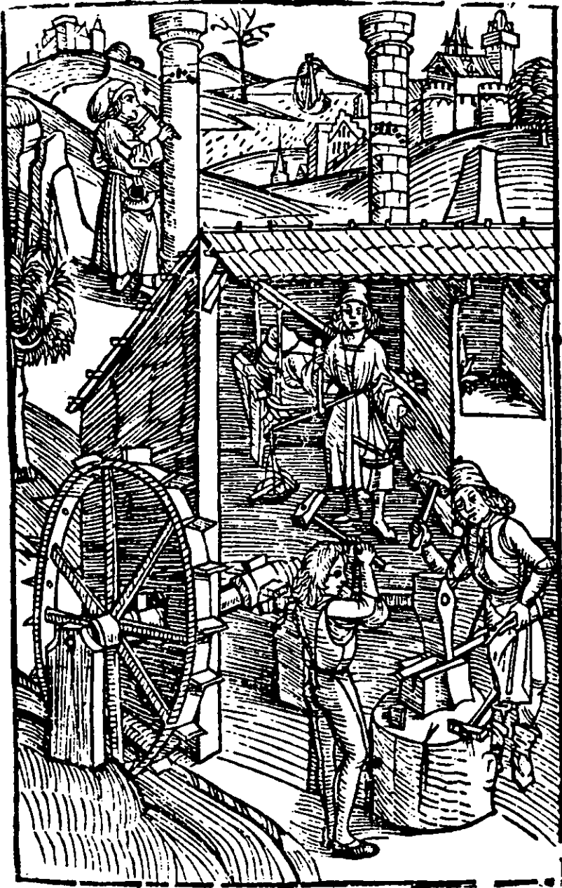
Schmiede mit Wasserradantrieb des Hammers (Schwanzhammer, Nockenwelle). Holzschnitt aus: Spechtshart, Flores musicae. Straßburg: J. Prüss 1488. (Oben Pythagoras, den Klang des Hammers erprobend.)
