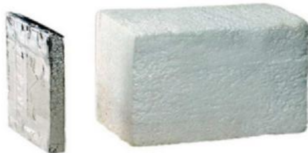
Abb. zeigt Vergleich 20mm VIP zu 200mm Polystyrol beide U-Wert 0,24 W/m²K
