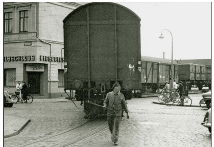
Auf der Efftinge- und der Holzmühlenstraße verkehrte die Industriebahn von 1916–1966. Da die Einmündungen leicht verschwenkt waren, sind an dieser Stelle, wenn die Bahn zu schnell durch die schlangenartige Kurve fuhr, öfter Wagen umgekippt.
