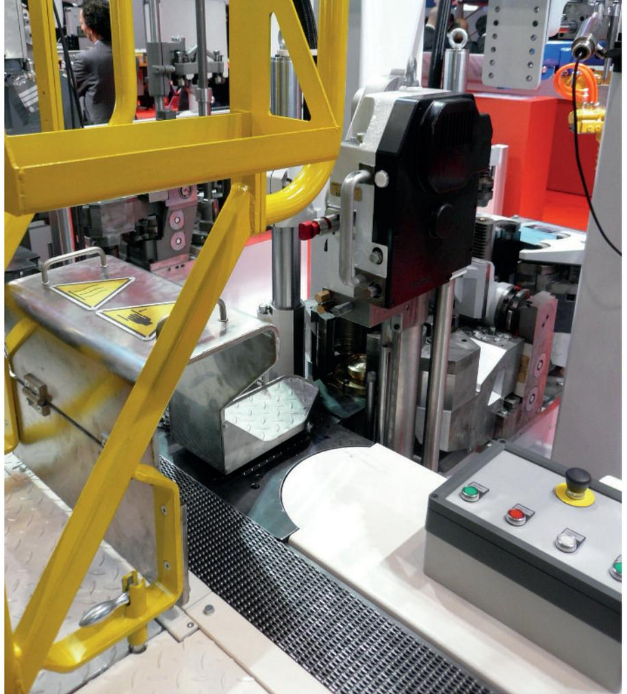
Das Förderband der Flaschenproduktionsmaschine kann sehr heiß werden. Eine spezielle Leiter mit einer isolierten Brücke über dem Band schützt die Beschäftigten und bietet einen sicheren Stand.
