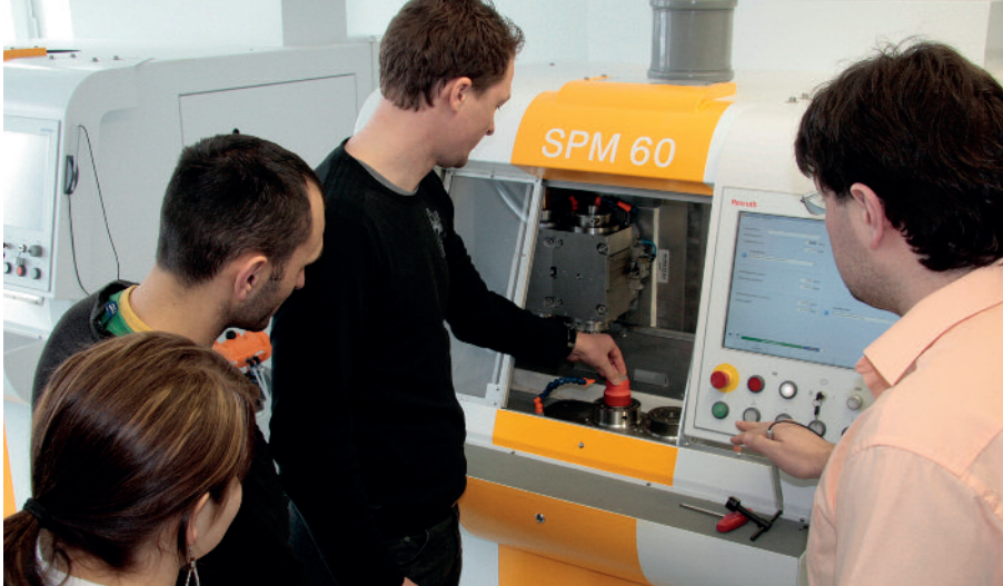
Während der zweijährigen Ausbildung zum Glastechniker mit Schwerpunkt Optik lernen die Auszubildenden auch den sicheren Umgang mit der CNC-Poliermaschine.
