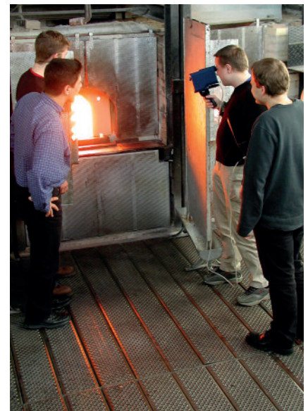
Glashüttentechniker messen die Temperatur am Glasschmelzofen mit einem Pyrometer.
