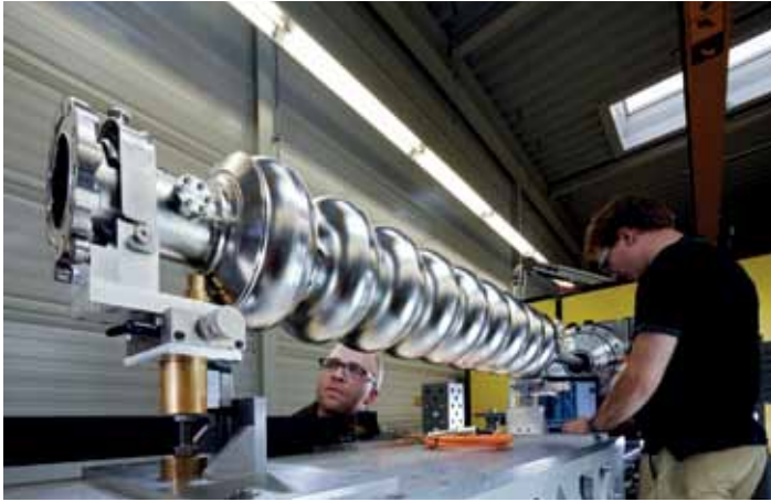
Ein Roboter mit einer eigens entwickelten Spezialkamera überprüft die Cavity auf Unreinheiten, unebene Stellen und fragwürdige Schweißnähte.
