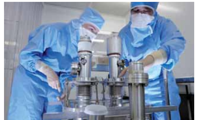
Diese im Verhältnis recht kleinen Bauteile leisten Großes: sie speisen die Hochfrequenz in die Cavity ein, mit deren Hilfe die Elektronen auf hohe Energien beschleunigt werden.
