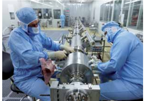
Acht dieser Cavities im Tank werden, zusammen mit allen nötigen Zuleitungen, zu einer Kette von acht Tanks zu einem Cavity-String zusammengesetzt – alles unter höchster Reinheit und Präzision.
