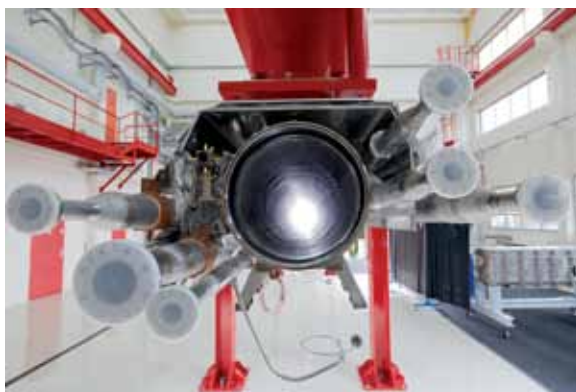
Dieses dicke Rohr leitet später das gasförmige Helium ab. Der Cavity-String muss noch angebaut werden, bevor der gesamte Aufbau im gelben Beschleunigermodul verschwinden kann.
