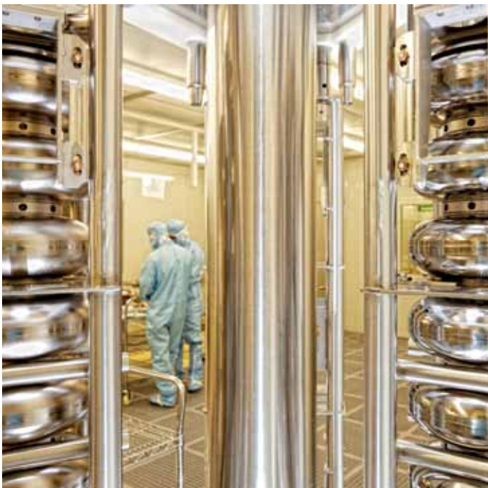
Nach Reinigung und Tests stehen die neunzelligen Schönheiten für den Einbau bereit.
