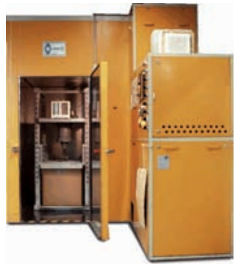
Härtetest: 28 Tage Zeitstandprüfung im Wechselklima zur Erforschung des Langzeitstandverhaltens von Verpackungsmaterial./Durability test: 28-day test cycle under changing climatic conditions to investigate the long-term stability of packaging materials.
