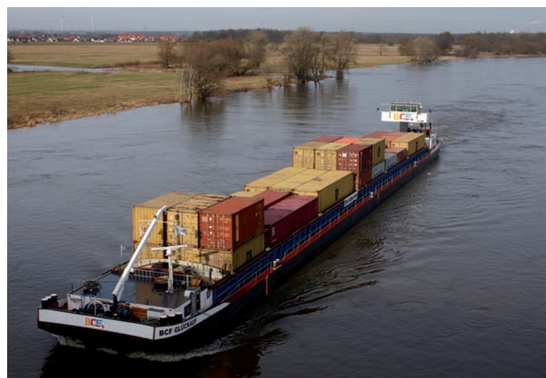
Dreilagig können bis zu 108 TEU mit dem neuen Flaggschiff MS „BCF Glückauf“ befördert werden./Up to 108 TEU can be loaded in three tiers on board the new flagship MS BCF Glückauf.
