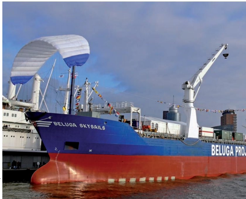
Die MS „Beluga SkySails“ mit ausgefahrenem Zugdrachen im Hamburger Hafen. The MS Beluga SkySails with her extended towing kite at the Port of Hamburg.
