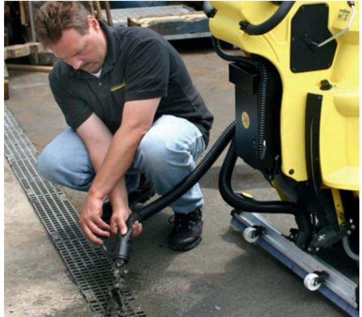
Leicht ausführbare Rüstfunktionen (hier: Entleerung einer Scheuersaugmaschine) entlasten das Zeit- und Kostenbudget.
