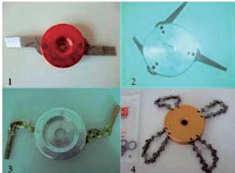
1. Werkzeug mit beweglichen Messern, 2. Werkzeug mit beweglichen Messern für Freischneider/Motorsensen, 3. Schlegelartiges Werkzeug für Freischneider/Motorsensen, 4. Werkzeug aus Motorsägenketten für Freischneider/Motorsensen (Abb.: Sozialversicherungsträger für den Gartenbau)
