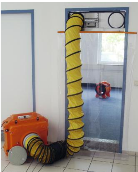
Staubfreies Arbeiten durch Unterdruck
