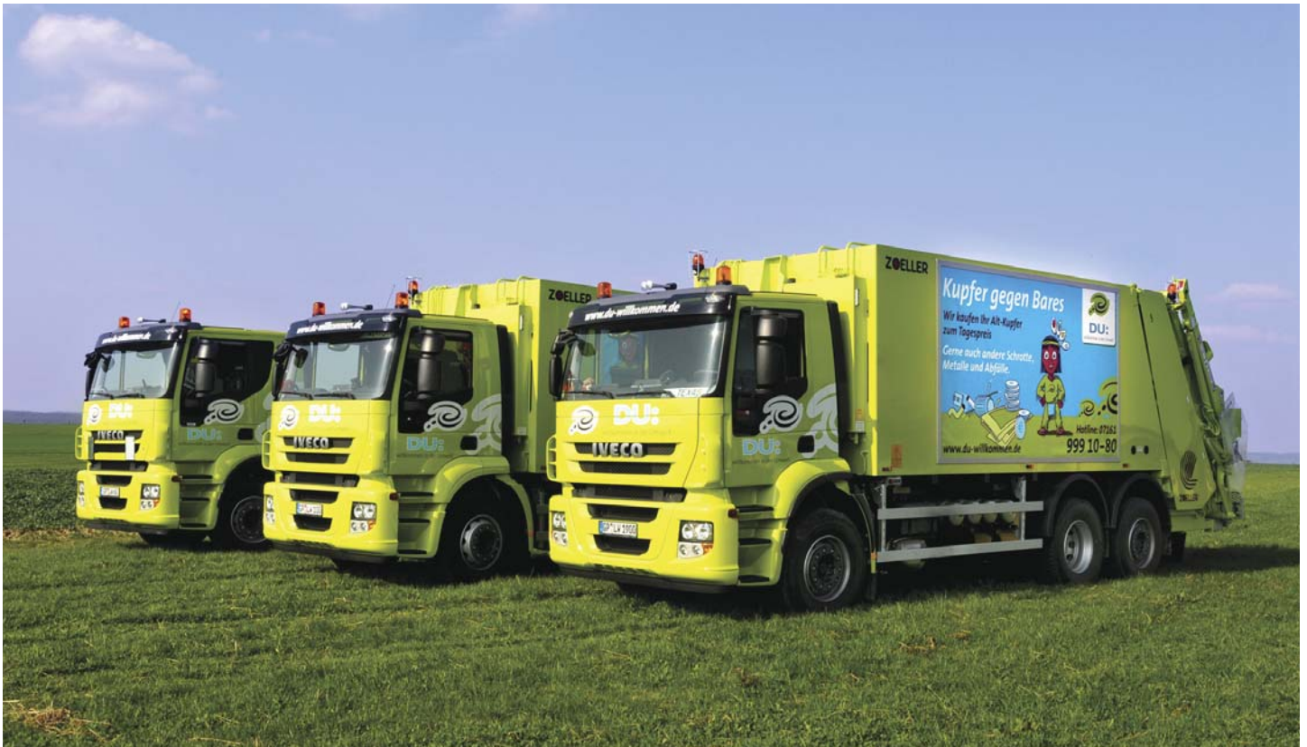
Leistung, Wirtschaftlichkeit, große Wendigkeit (durch gelenkte Nachlaufachse) sowie Motoren- und Getriebevielfalt sind für ETG (Entsorgung + Transport GmbH), Göppingen, die Vorteile des Iveco Stralis. Im Bild: Drei neue Stralis-Dreiachser erhöhen den Anteil dieser Fahrzeuge auf 25 % im 35 Einheiten umfassenden ETG-Fuhrpark. (Foto: Iveco Magirus)
