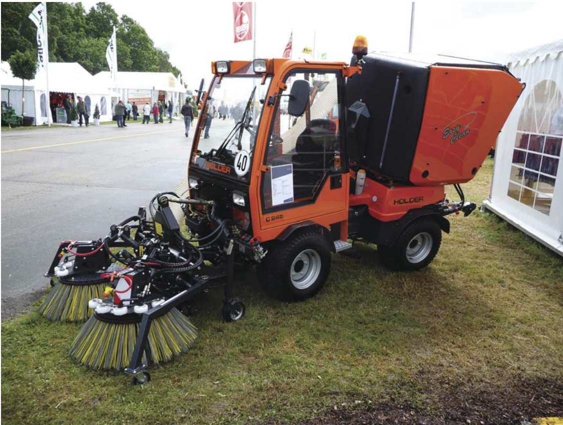
Der Holder C245 mit voller Kehrausrüstung für den Einsatz auf schmalen Wegen oder Flächen mit Hindernissen
