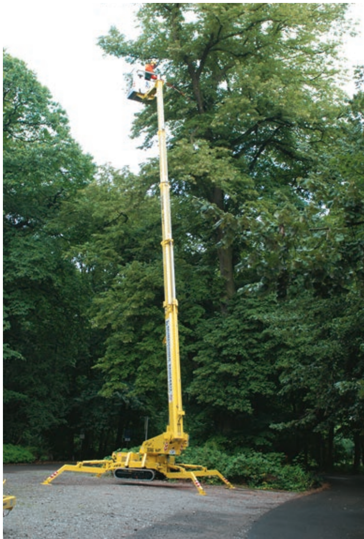
Kettenbetriebene Hubarbeitsbühne erlaubt ein sicheres Arbeiten in der Höhe. (Foto: Teupen Maschinenbau GmbH)
