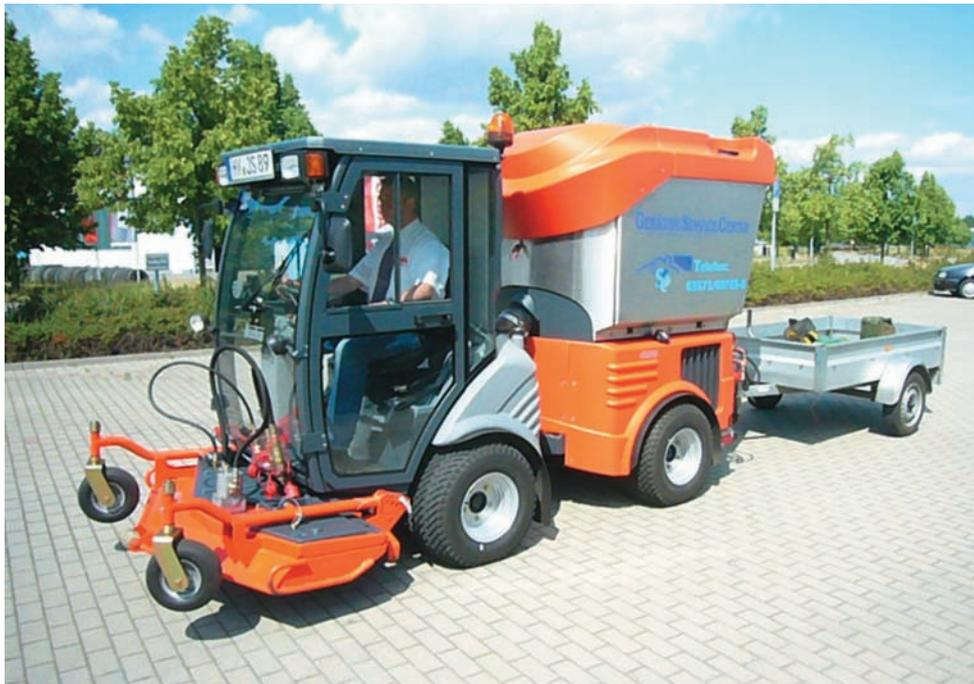
Hako-Citytrac 4200 DA mit einem hydraulisch angetrieben Frontmäherwerk und Anhänger ((Aufmacher))
