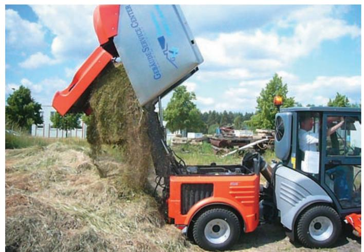
Bequemes Entleeren mit Hilfe der hydraulischen Hochentladung.
