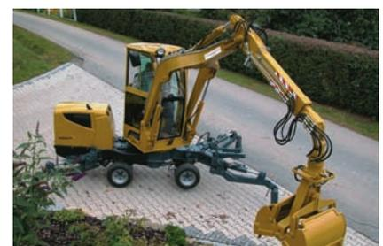
re Allradlenkung, das Hundegangfahren sowie der kleine Wenderadius (980 mm) machen den Bagger wendig und erlauben eine untergrundschonende Fortbewegung. Eine hydraulisch verriegelbare Pendelachse sorgt für Sicherheit in schwierigem Gelände, z.B. an Hängen und Böschungen, und ermöglicht das Baggern ohne Abstützung.
