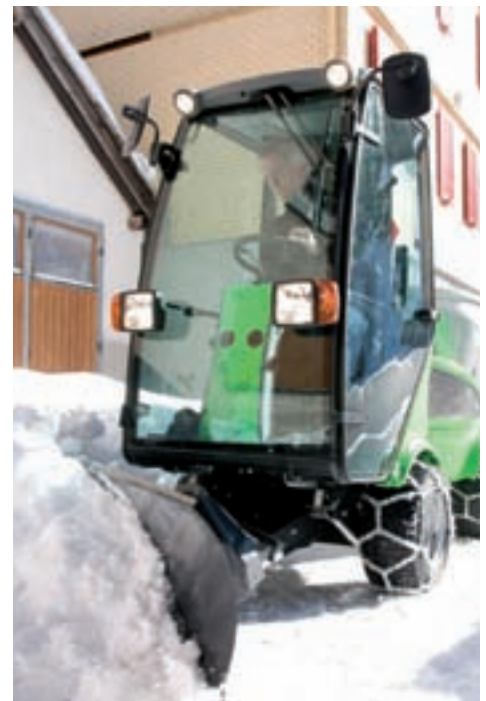
Der Egholm 2200 im Wintereinsatz mit seinem speziell geformten Schneeräumschild
