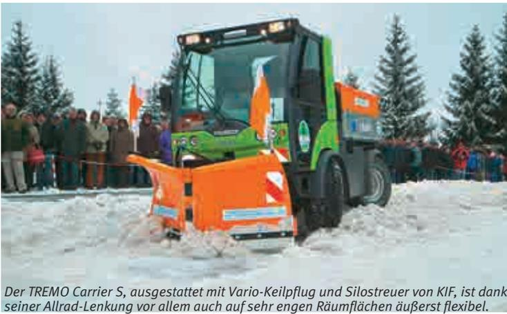
Der TREMO Carrier S, ausgestattet mit Vario-Keilpflug und Silostreuer von KIF, ist dank seiner Allrad-Lenkung vor allem auch auf sehr engen Räumflächen äußerst flexibel.
