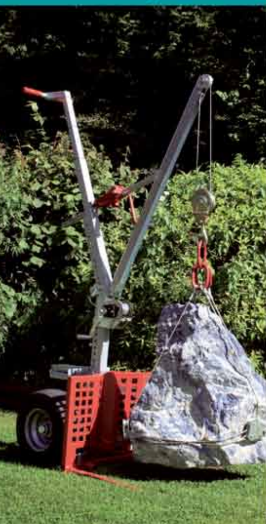
Kran zum Anheben, Transportieren und punktgenauem Absetzen von Findlingen und Quellsteinen
