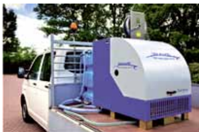
Kompaktes Gerät für die Wildkrautbekämpfung mit Handlanze mittels WAVE Mid Series. (Fotos: WAVE Europe)
