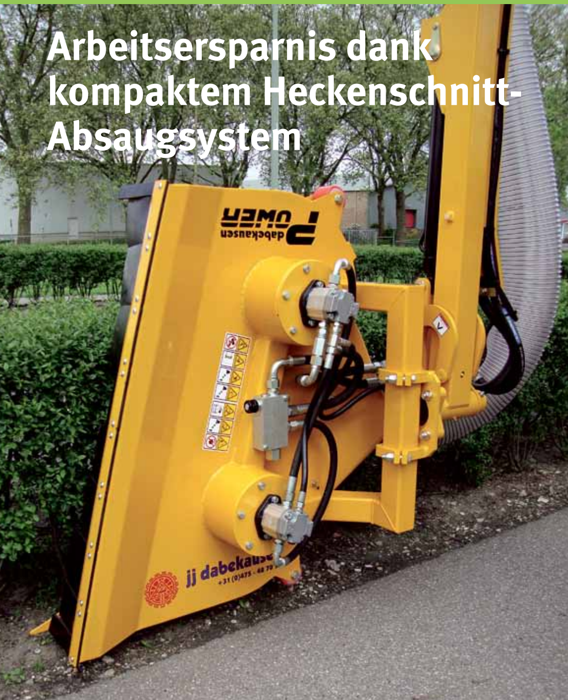
Der RM1250pro kann auf Wunsch geliefert werden mit oder ohne Absaugmöglichkeit. Wenn ohne dann wird das geschnittene Material fein gehäckselt und fällt zurück in die Hecke. (Foto: DABEKAUSEN)
