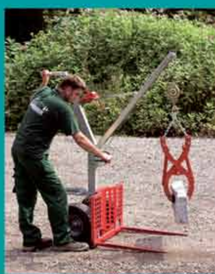
Kran und Steinzange
