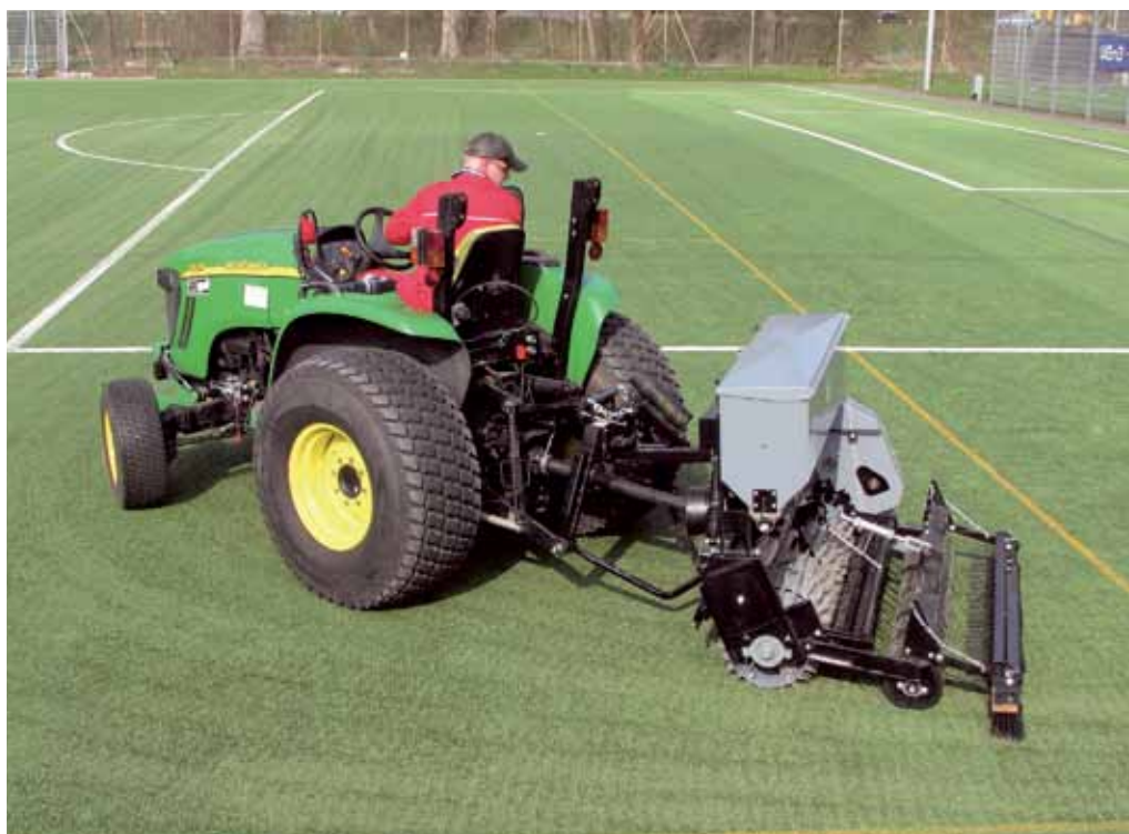
Der AERA-vator mit Multi-Zinkenwelle lockert die Kunstfaser auf. Durch die Vibration und Taumelbewegung der Rotorwelle wird das Granulat an die Oberfläche gehoben. Die Bürste verteilt das Granulat und egalisiert es anschließend durch das Ziehen. (Foto: Quarzsandwerk LANG GmbH & Co KG)
