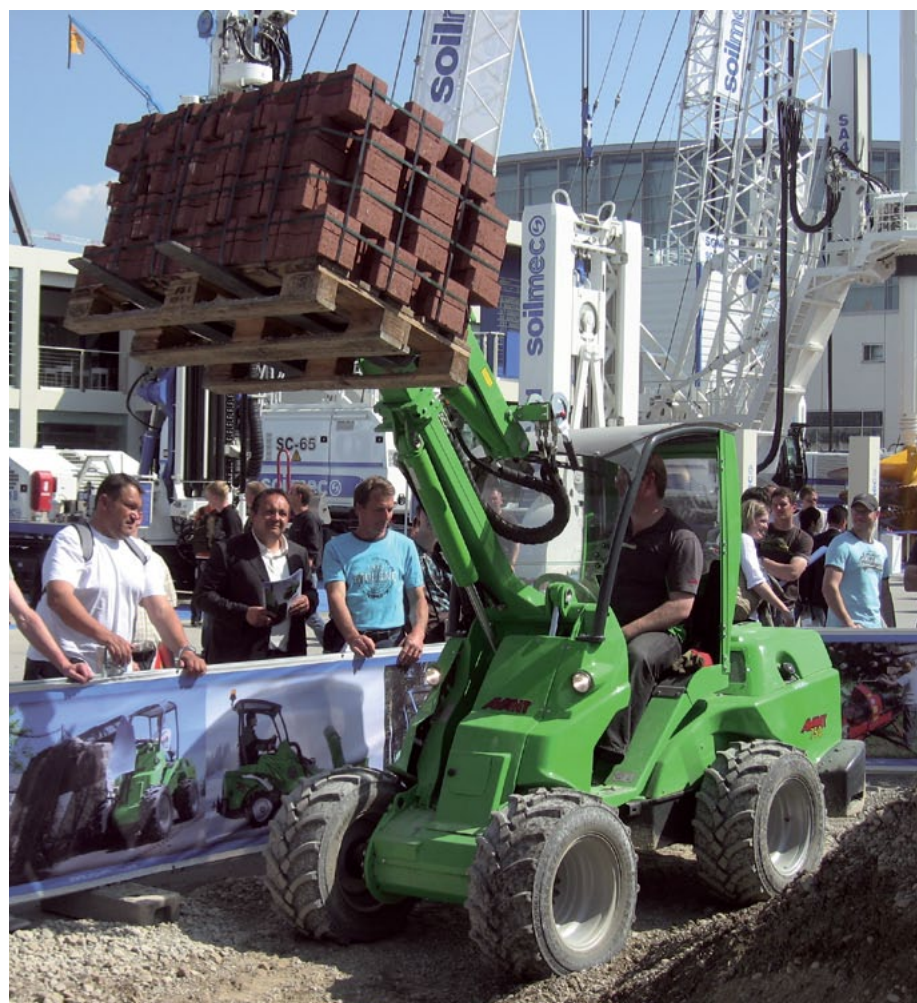
Auch der AVANT 750 – mit 2 t Einsatzgewicht das Flaggschiff der AVANT Multifunktionslader – ist durch einen niedrigen Schwerpunkt extrem standfest. (Foto: AVANT TECNO Deutschland GmbH)
