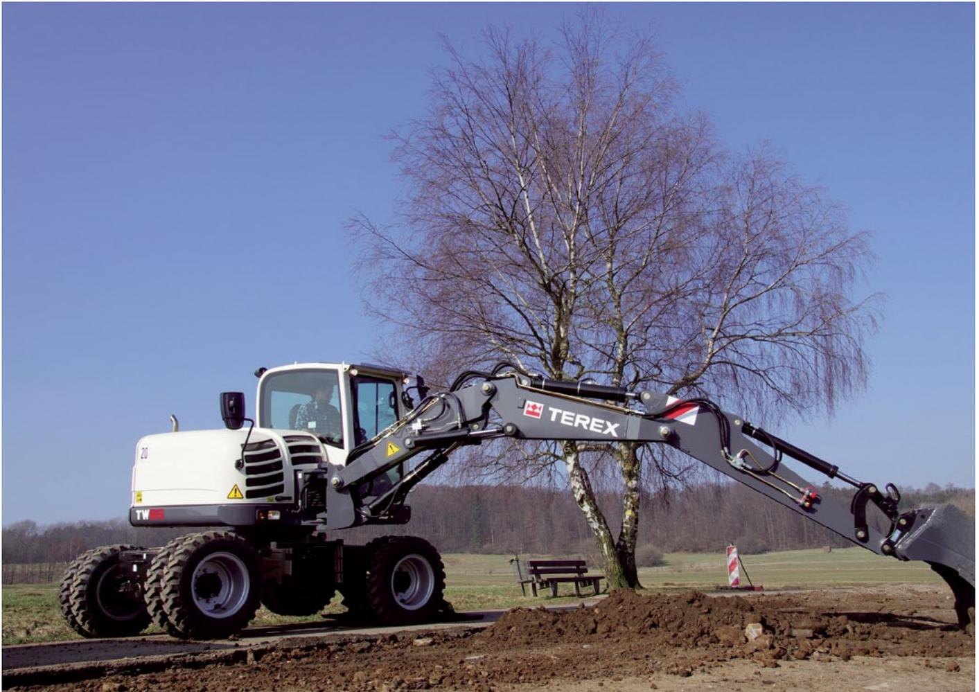
Fahr- und Arbeitskreise sind bei Terex-Mobilbaggern komplett getrennt, was höchste Produktivität und Beweglichkeit garantiert. Der gezeigte TW85 hat einen auf 2200 mm verlängerten Löffelstiel am Gelenkausleger. (Foto: Terex Deutschland GmbH)
