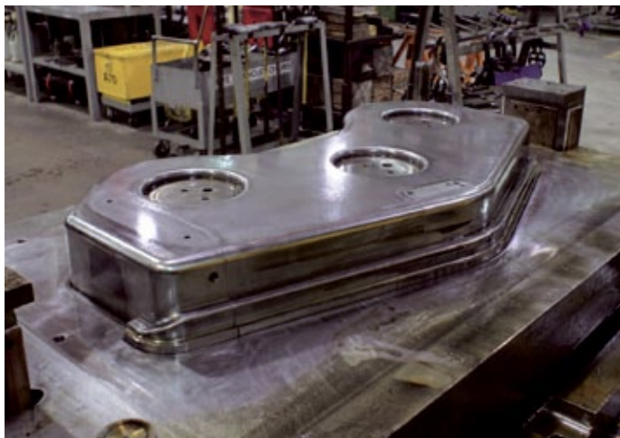
Mit einem Druck von 2.000 Tonnen wird das Presswerkzeug in das Metall gerammt.
