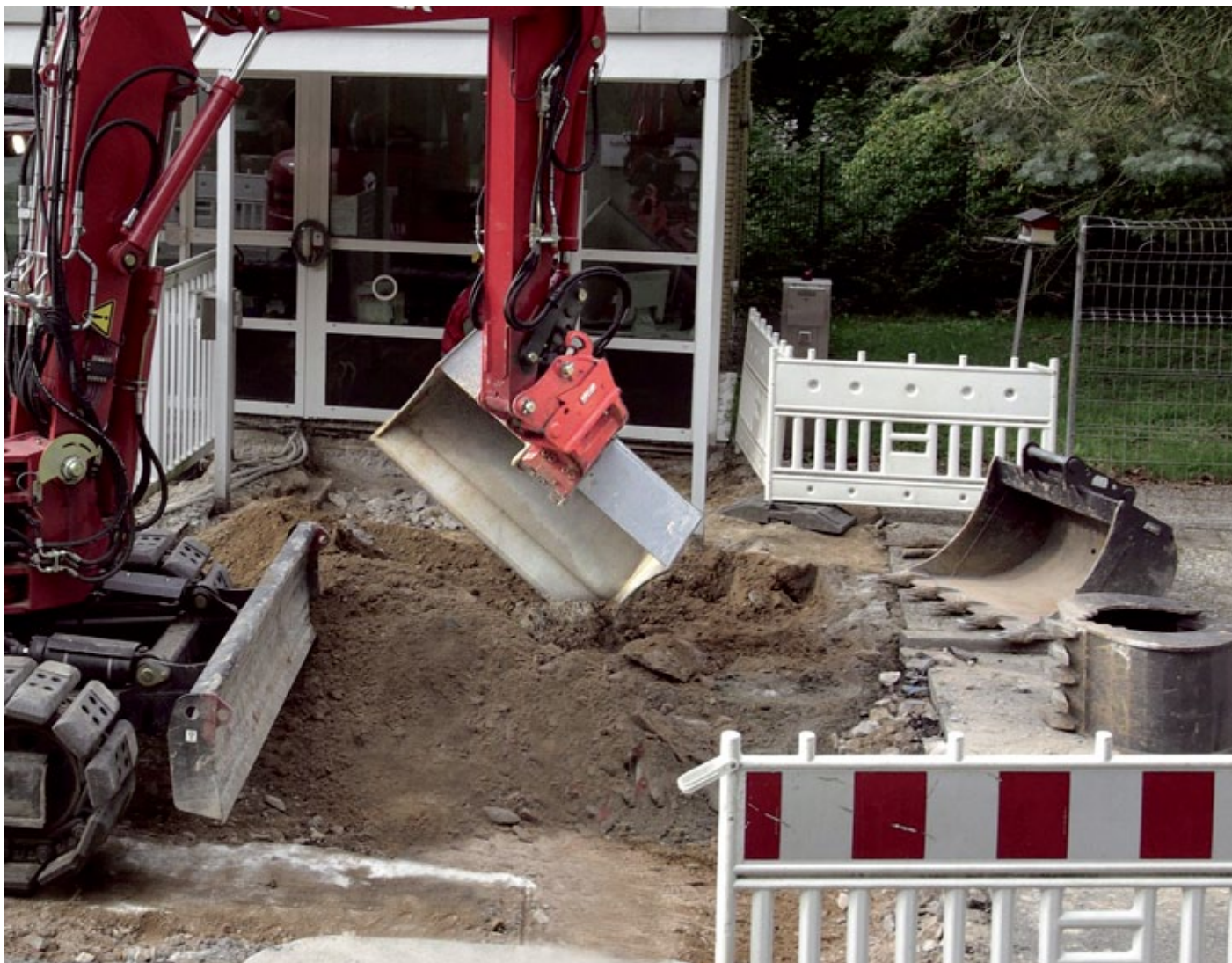
Mit 2x70° Schwenkwinkel bietet der Lehmatic Powertilt höchste Flexibilität auf der Baustelle. (Foto: Lehnhoff Harstahl GmbH & Co. KG)
