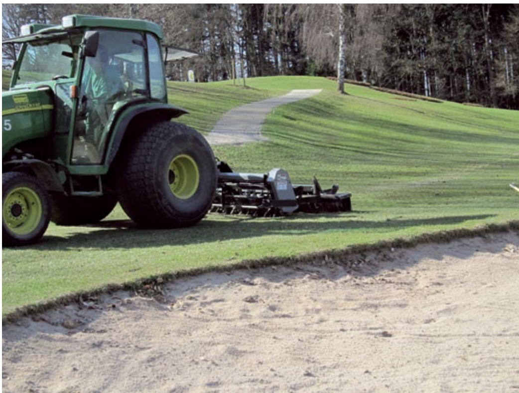
Durch die Fahrgeschwindigkeit der Zugmaschine wird die Verweildauer der Zinken-Vibration pro Quadratmeter geregelt. Dadurch wird der aufgebrauchte Oberboden optimal in den Vegetationshorizont eingearbeitet, ohne Aufhäufungen (wie dies z.B. eine Fräse verursacht). Eine Nachplanie ist nicht erforderlich. Das spart enorm Zeit. (Foto: Quarzsandwerk LANG GmbH & Co. KG)
