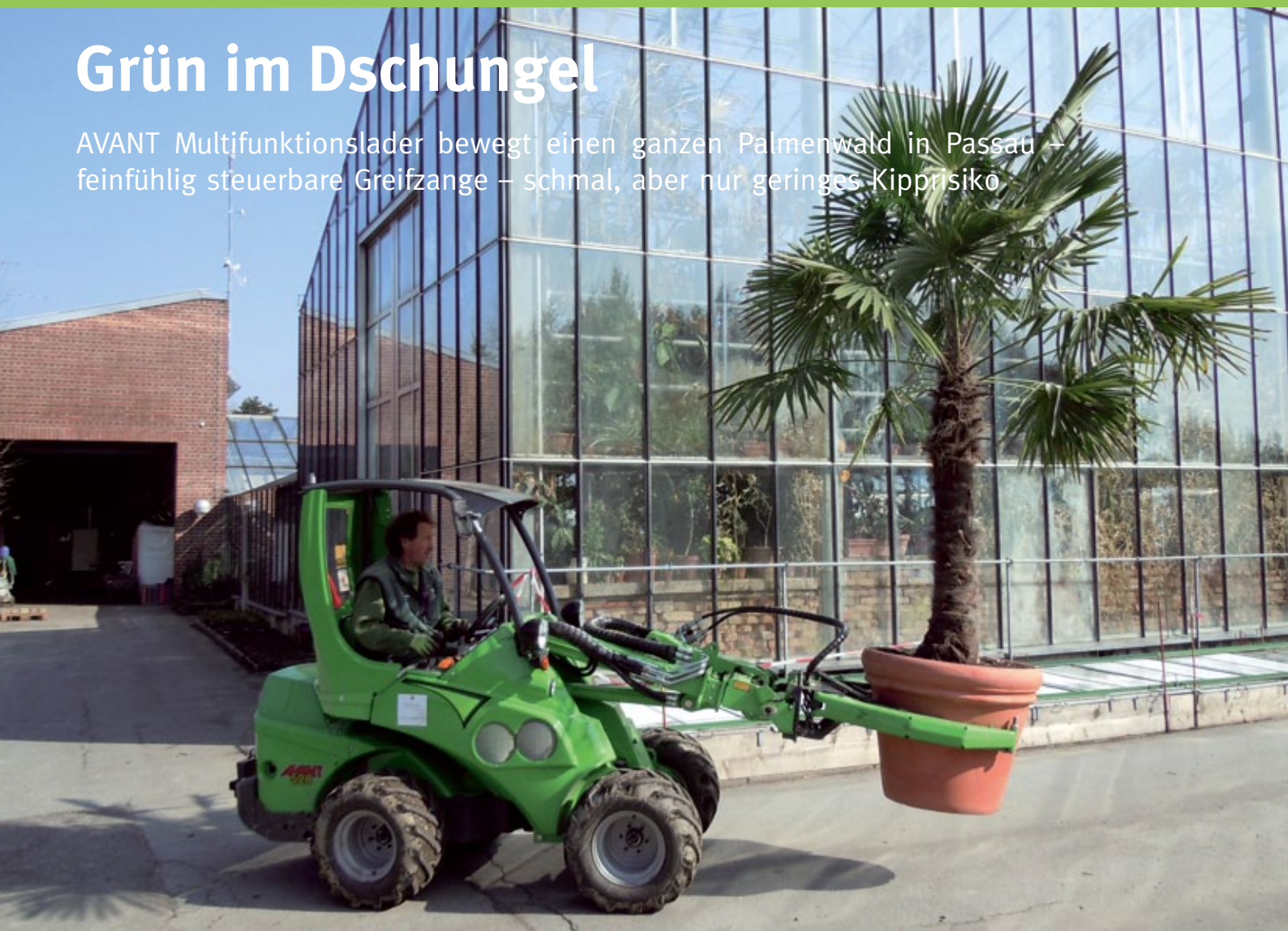
Der AVANT 528 kann mit seiner Universalgreifzange Pflanzentöpfe mit einem Durchmesser bis zu 1.200 mm feinfühlig greifen und bis 650 kg heben. (Foto: AVANT)
