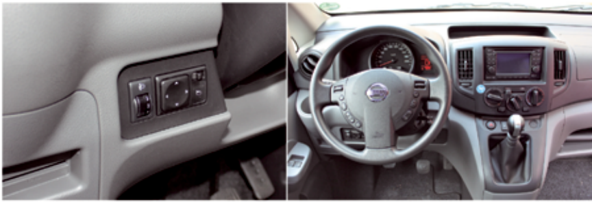
Versteckte Bedienung für Spiegel und Scheinwerferregulierung, nur ein Rundinstrument im „Cockpit“
