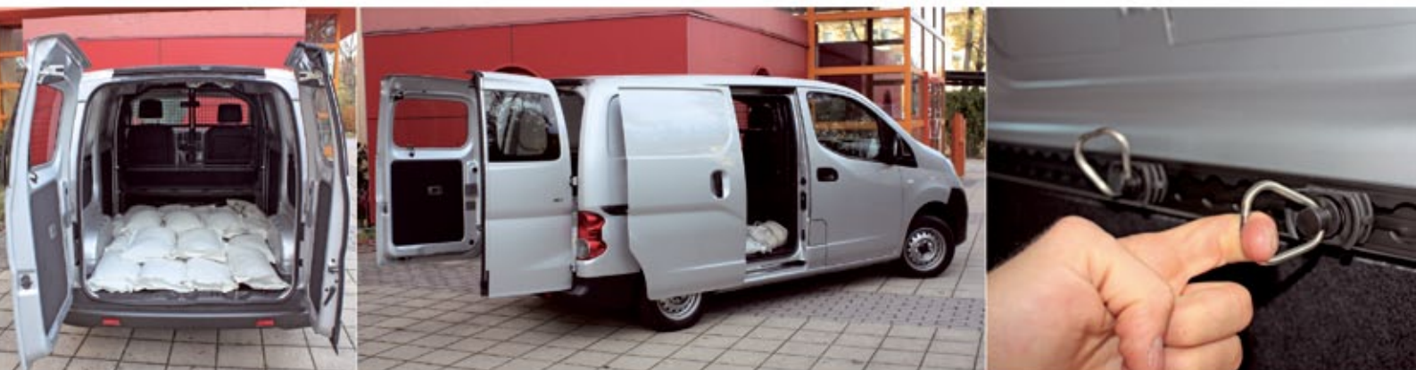
Lediglich 490 Kilo Nutzlast beim Testwagen, dafür 4,2 Kubik Volumen, eine rechte Schiebetür ist immer Serie, seitliche Zurrösen dagegen nur im „Premium“
