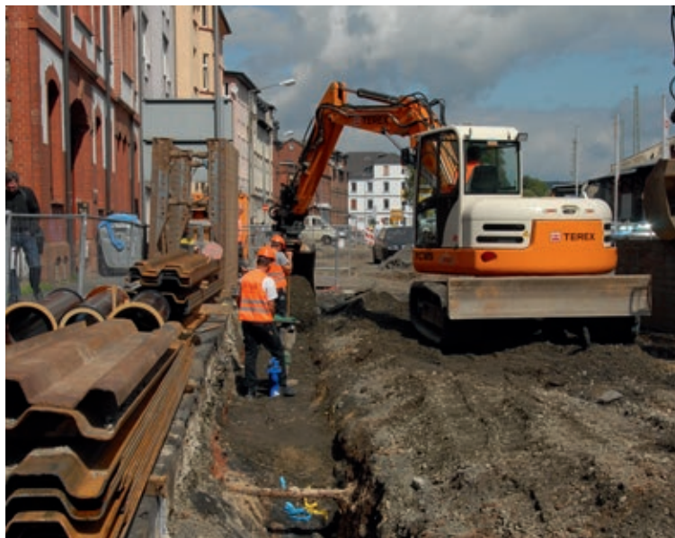
Mit seinem Kurzheckradius eignet sich der kompakte Terex TC125 auch für Einsätze auf beengten Baustellen. (Foto: Terex Construction)
