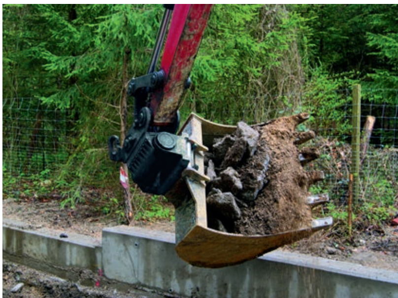
Für Bauhöfe, Autobahnmeistereien, Tief- und GaLaBau gleichermaßen interessant – der neue Schwenkantrieb RA09 für Midi-Bagger: Kompakt, niedrig und stark ermöglicht er die optimale Beweglichkeit der Anbaugeräte. (Foto: KINSHOFER)
