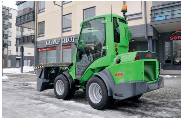
Mit der neuen AVANT DLX-Kabine mit Klimaanlage werden die Multifunktionslader noch stärker zu Ganzjahresmaschinen. (Foto: AVANT TECNO Deutschland GmbH)
