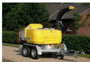
Holzzerkleinerer TS 450 M für Materialstärken bis 23 cm Durchmesser. (Fotos: TS Industrie GmbH)
