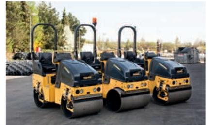
Die neue BOMAG -5 Generation der leichten Tandemwalzen (Foto: BOMAG GmbH)
