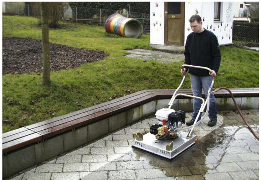
Effizientes Reinigen mit dem neuen Easy-Clean EC. Durch die schnell drehenden Spezialdüsen wird die bekannte Streifenbildung vermieden. (Foto: Probst)
