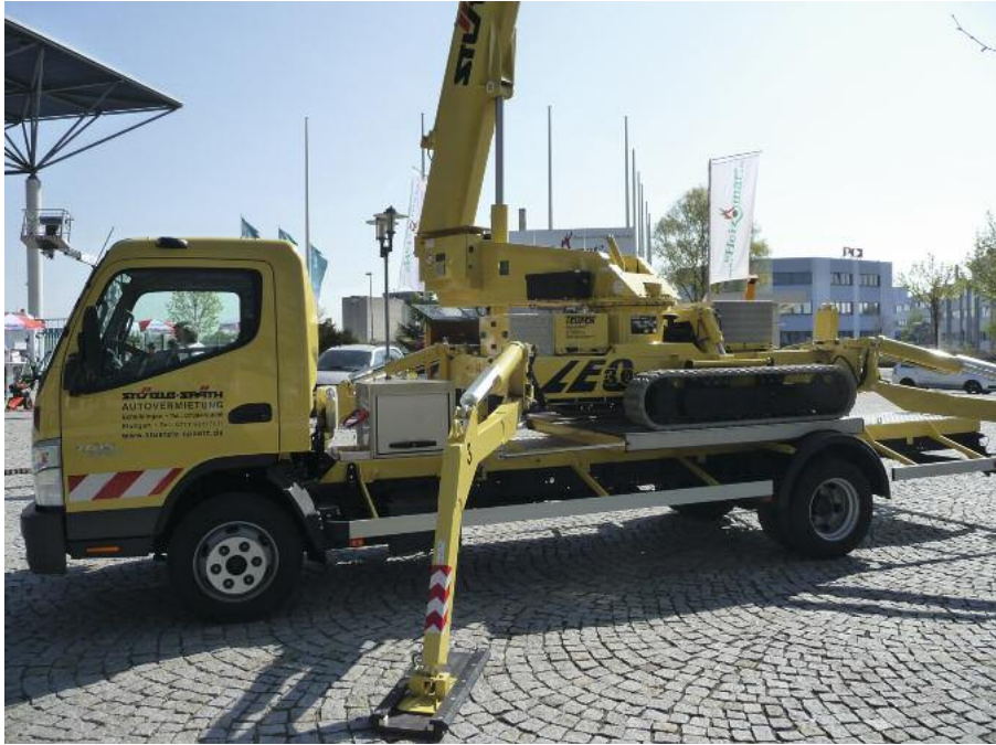
Flexibel im Einsatz ist der Hubsteiger bei dieser aufgesattelten Variante. (Foto: Matthias Donners)
