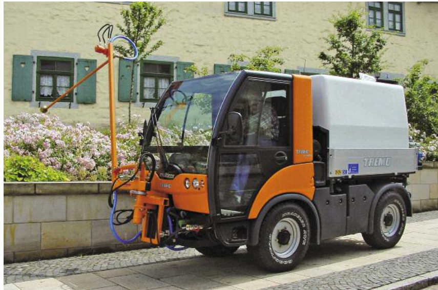
Multicar TREMO Carrier mit Gießbarm. (Foto: Multicar - Zweigwerk der Hako-Werke GmbH)
