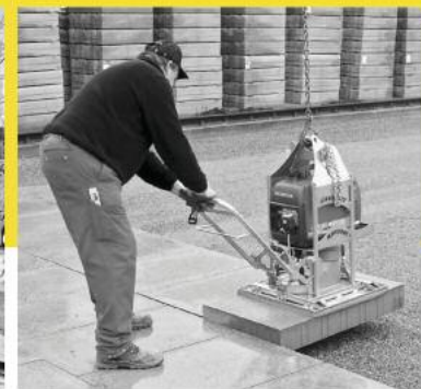
Das Vakuum Hebegerät QUICKJET QJ 600 e: saugt selbst poröses Greifgut schnell und sicher!
