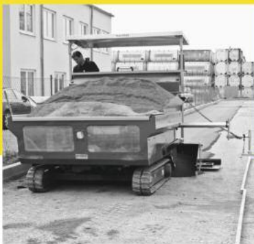
Flächenfertiger POWER PLAN PP: Materialverteilung und perfektes Planum in einem Arbeitsgang
