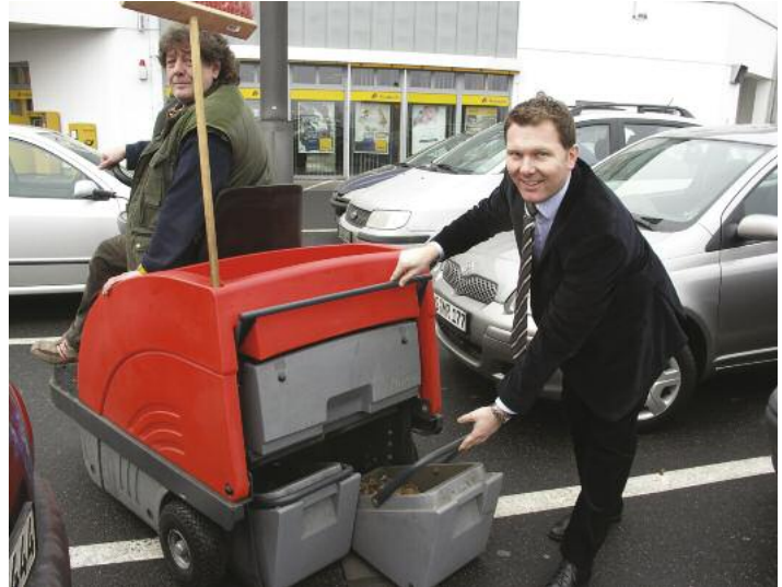
Die beiden Schmutzbehälter sind für eine Person schnell und einfach zu leeren, wie Manfred Wittmann demonstriert.
