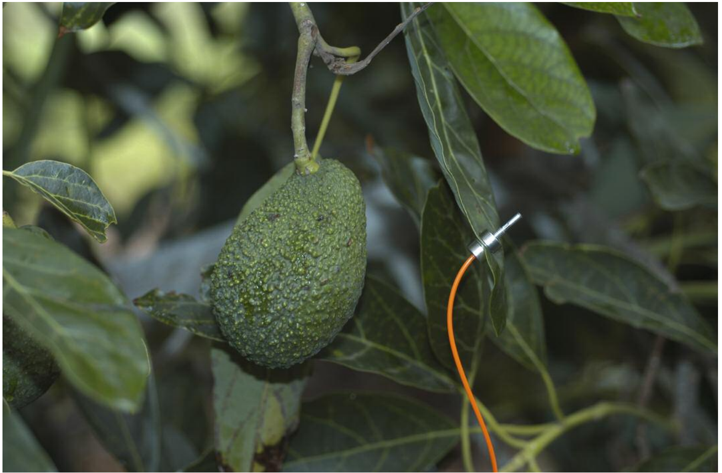
Die Langzeitüberwachung zur Bewässerungssteuerung arbeitet mit nichtinvasiven Drucksensoren. (Foto: NTBB)
