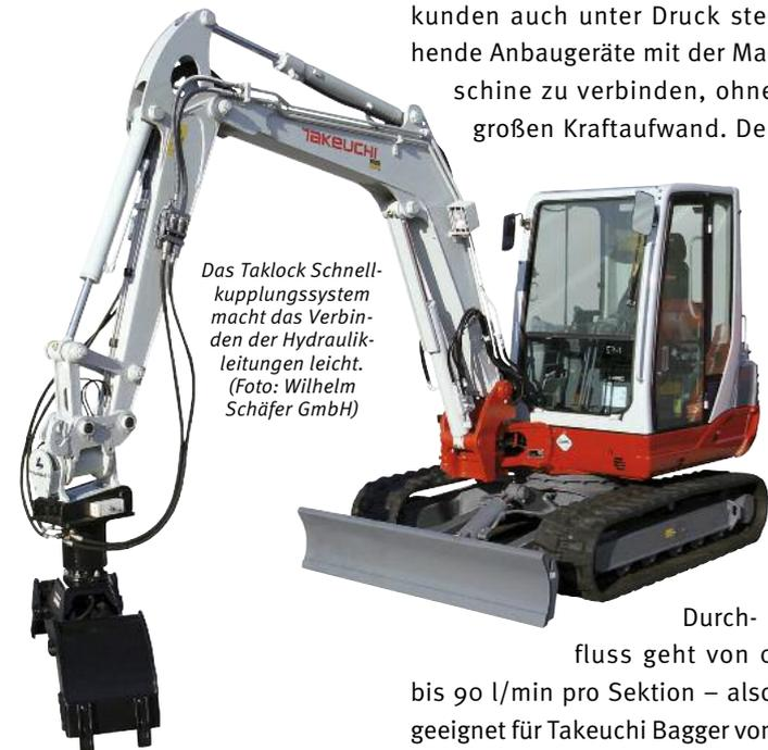
Das Taklock Schnellkupplungssystem macht das Verbinden der Hydraulikleitungen leicht. (Foto: Wilhelm Schäfer GmbH)
