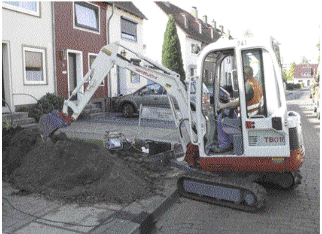
Durch sein auf 1,30 m Breite teleskopierbares Fahrwerk kann der Takeuchi Minibagger TB 016A seine Kraft mit großer Standsicherheit entfalten
