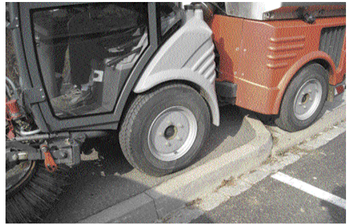
Bordsteine sind für die gedämpfte Knicklenkung kein Hindernis.
