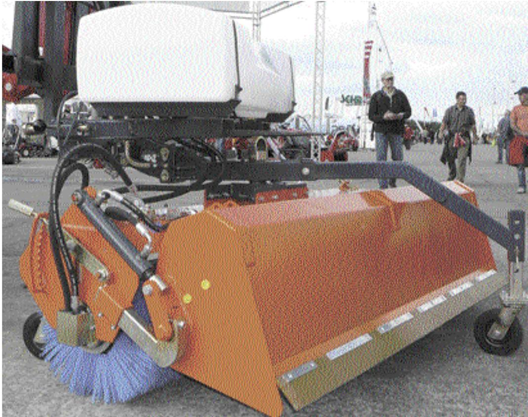
Tuchel Plus Anbaukehrmaschine mit Freikehrinrichtung (Foto: Tuchel Maschinenbau GmbH)
