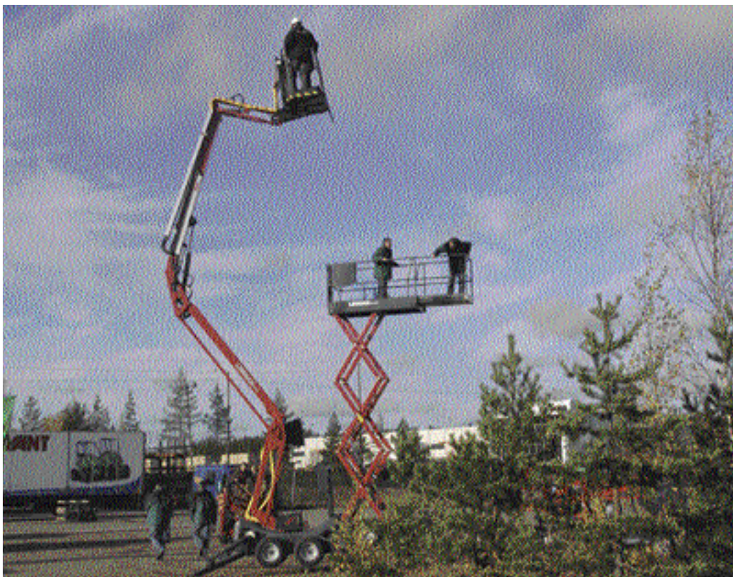
Die LEGUAN 160 Arbeitsbühne ist geländegängig und reicht für eine Arbeitshöhe bis zu 15,6 m. (Foto: AVANT TECNO Deutschland GmbH)
