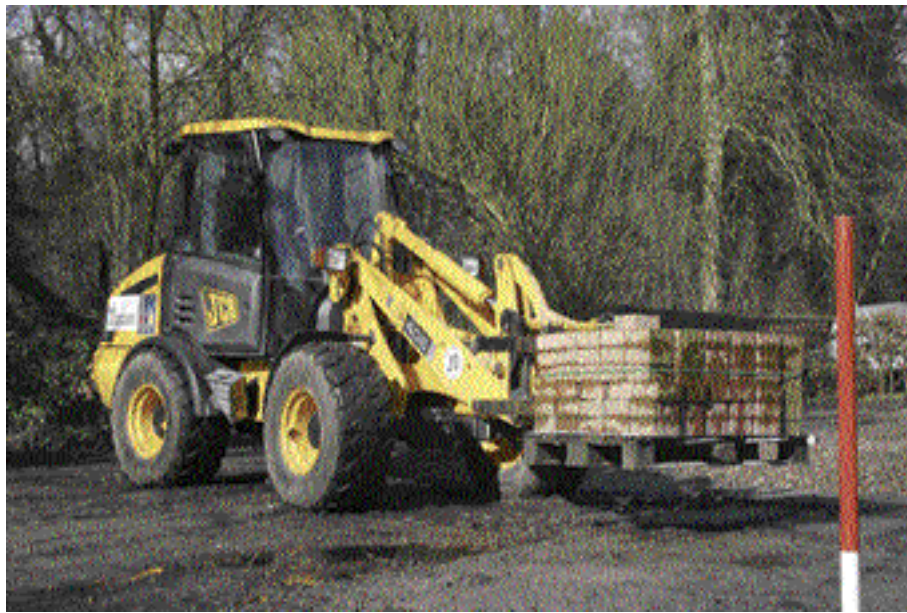
Der 0,8-m 3 -Radlader 406 von JCB besitzt eine Hubkapazität von zwei Tonnen und ist dank serienmäßigem Schnellwechsler und großer Anbaupalette sehr vielseitig einsetzbar. (Foto: JCB Deutschland GmbH)
