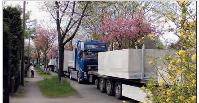
Schwertransporter in Überbreite lieferten die gewaltigen Betonfertigteile an, die von einem mobilen Kran in die Baustelle eingelassen wurden. Fotos: H. Fricke
