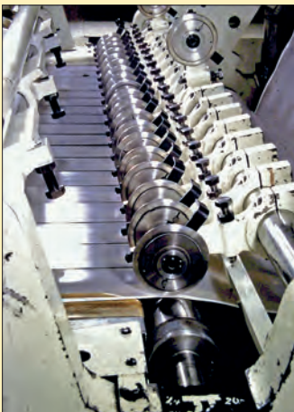
Eine Maschine schneidet die großen Bahnen in schmale Streifen. Auch eine von Hand bediente Schneidmaschine stand im Fertigungsraum.
