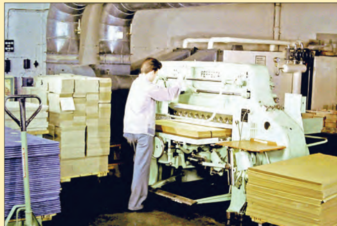
Eine Maschine schneidet die großen Bahnen in schmale Streifen. Auch eine von Hand bediente Schneidmaschine stand im Fertigungsraum.
