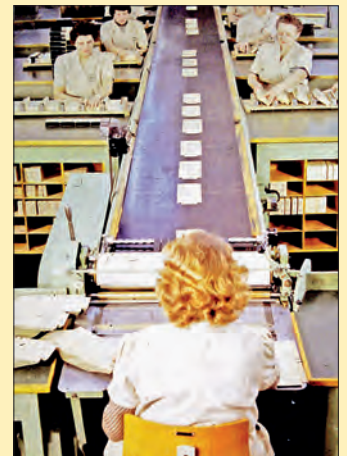
Für die Konfektionierung in die einzelnen Packungsgrößen saßen weibliche Mitarbeiter an langen Laufbändern.
