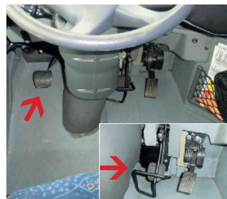
Bus mit zusätzlichem Bremspedal links und Sperre auf dem rechten Bremspedal.
