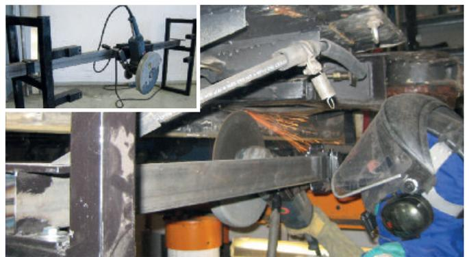
Die körperliche Belastung und die Unfallgefahr beim Trennschleifen an Straßenbahnfahrzeugen wurde durch eine Aufnahmevorrichtung reduziert.
