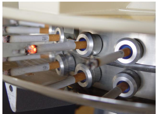
*Abbildung: Abrauchanlage zur Untersuchung von Zigaretten*
