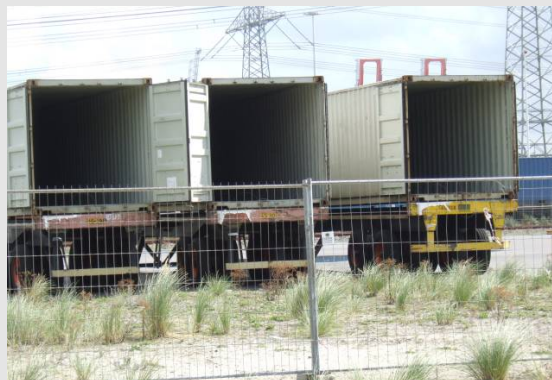
Abb. 1: Begaste Container, deren Türen für die Messungen geöffnet worden waren
