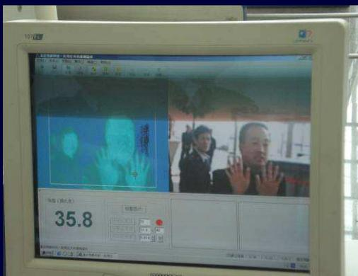
Abb. 3: Erprobung des Instrumentes zur Zertifizierung von Häfen/Flughäfen der WHO in China 2008. Thermoscanner am Jinan-Airport
