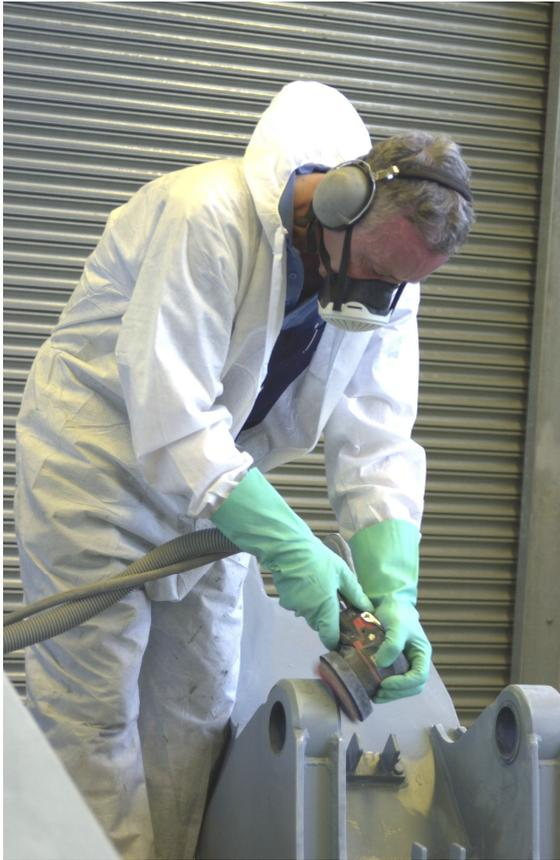
Belastung in Folge thermischer Zersetzung bei Schleifarbeiten
