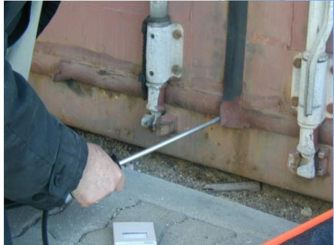
Einführen der Strahlmesssonde durch die Gummidichtung – Foto: Dräger AG
