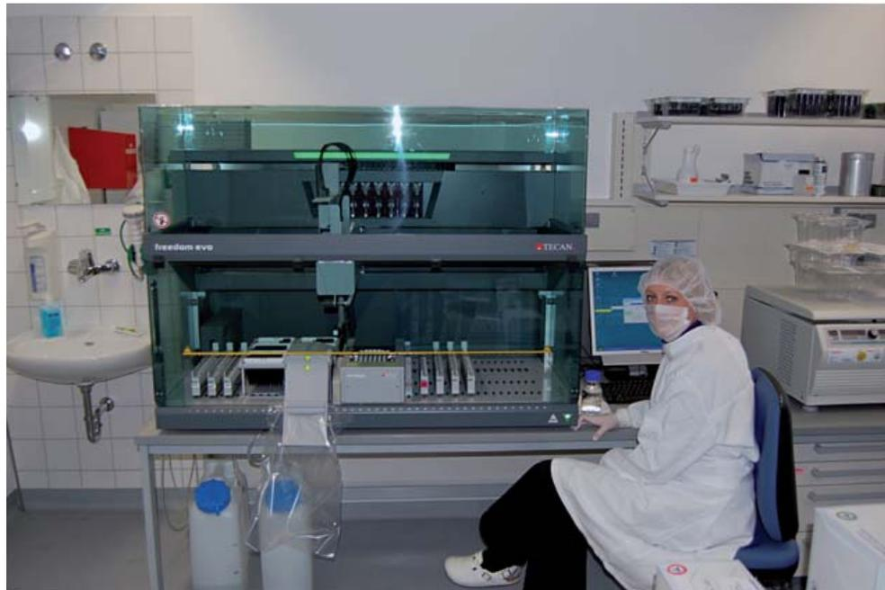
Pipettierroboter für die Präparation von DNA aus Spuren
