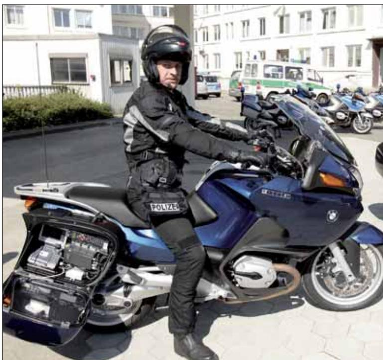
Das neue ProVida-Krad mit kompletter Videoanlage im Seitenkoffer
