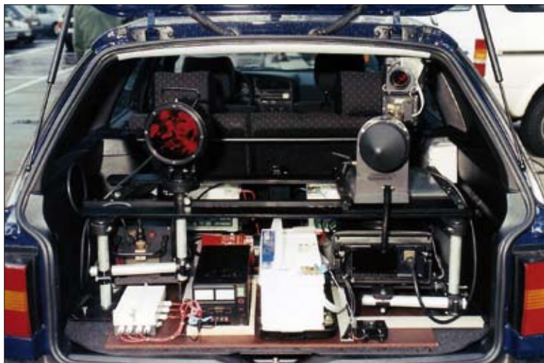
Bild unten: Radarwagen aus dem Jahr 1996: Ein VW Passat III Kombi (1600 ccm und 72 PS)
