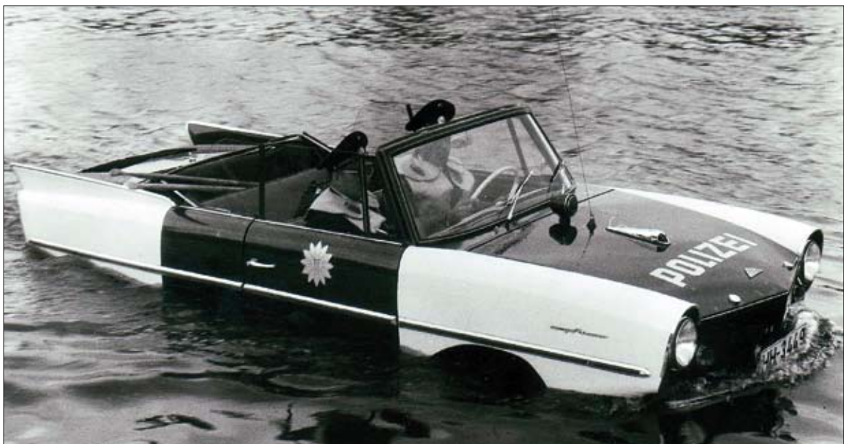
Ein Amphibienfahrzeug, im Polizeijargon „SchwimmKw“ genannt. DKW Amphicar, Bj. 1964, 1,2l, 4 Zylinder, 38 PS. Es wurde nach der Flutkatastrophe von 1962 angeschafft und war bis 1971 im Einsatz
