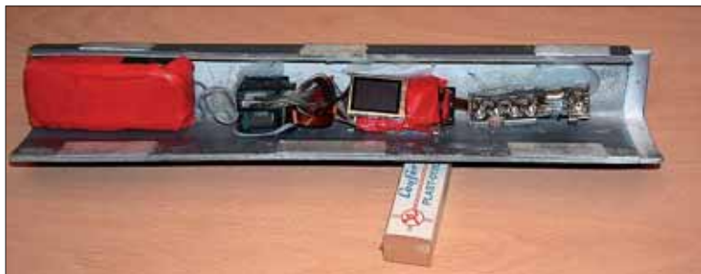
Das Innenleben: Kamera mit Speichereinheit für drei Stunden
