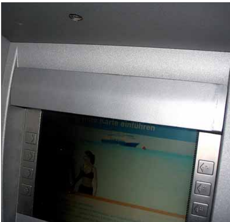
EC-Automat mit nachträglich aufgesetzter und manipulierter Blende
