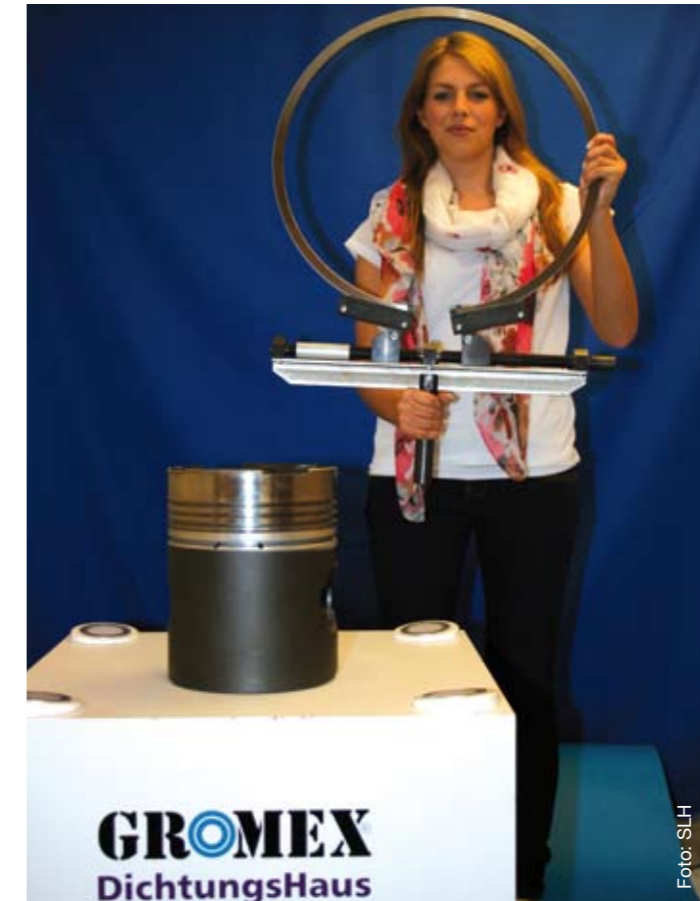
Kinderleicht zu bedienen: Der Spanner passt für alle Ringstöße
