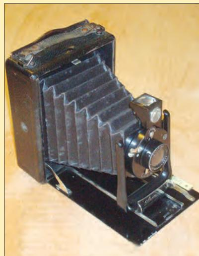
Ein Handapparat aus der Produktion der Leonar-Werke, die vorher ausschließlich Stativapparate hergestellt haben.
