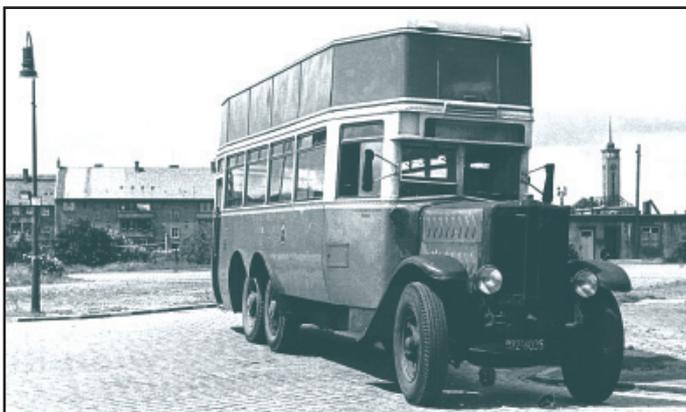
Bei Kriegsbeginn beschlagnahmte die Wehrmacht Omnibusse der HHA, so dass einige Linien verkürzt werden mussten. Die Kraftstoffverknappung führte 1942 dazu, Leuchtgas als Antrieb für Busse einzuführen. Auf das Dach der Wagen wurde eine Ballonhülle gesetzt und verkleidet. Eine Füllung reichte für 15 Kilometer.
