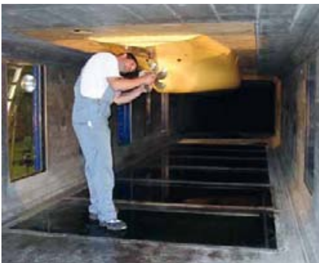
Die Montage eines Propellers am Modell im HYKAT (hydrodynamischer Kavitationstunnel)
