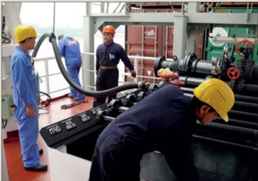
Beim Bunkern, hier von Schmieröl, muss jeder Handgriff sitzen und darf nichts „daneben gehen“
