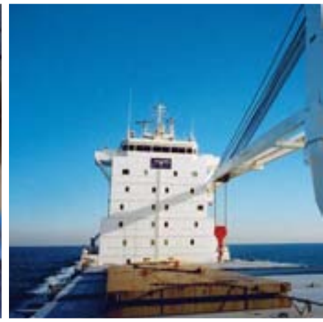
250 Tonnen hebt jeder der beiden Krane.
