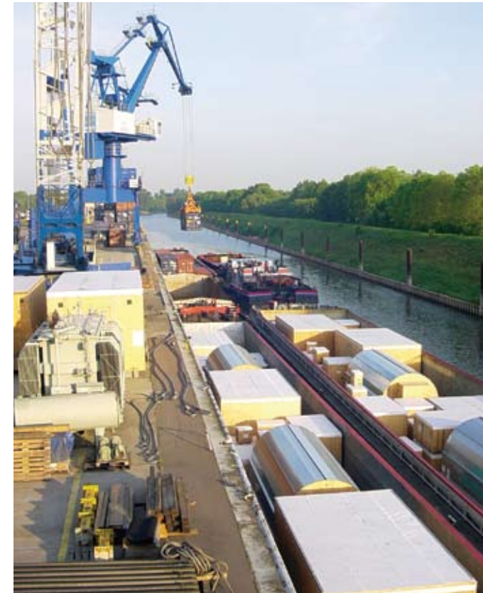
Der Hafenmobilkran kann bis zu 270 Tonnen heben
