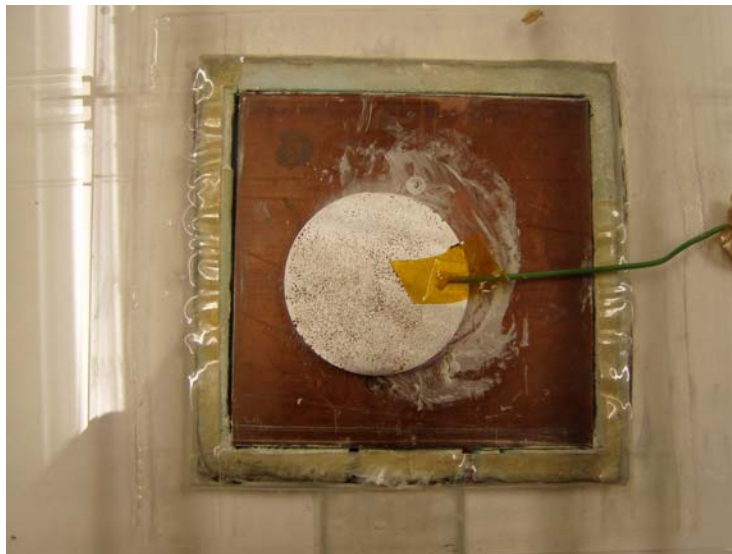
Abb. 8: Blick auf eine Messzelle mit Probe (Ronde aus Stahl.) Auf der Ronde befindet sich ein Temperaturfühler
