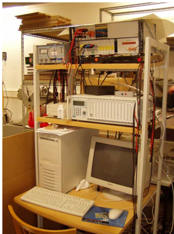
Abb. 9: Steuerung, Prozessablauf / Datenerfassung und Verarbeitung
